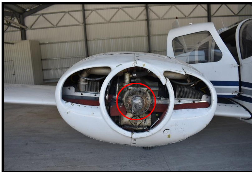
Fotografía No. 3 Daños en el motor RH por paro repentino.
