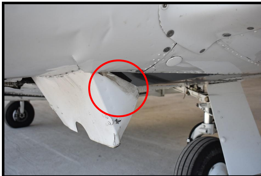
Fotografía No. 8 Daños en cowl flaps de motor LH.
