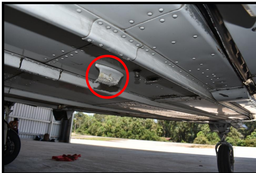
Fotografía No. 10 Daños en antena VHF.
