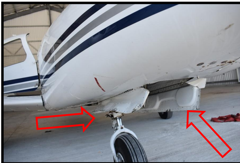
Fotografía No. 4 Daños en la compuerta del tren de nariz.
