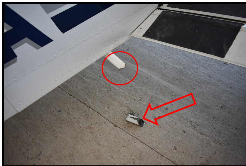
Fotografía No. 9 Apoyador de pie fracturado por compresión y abrasión.
