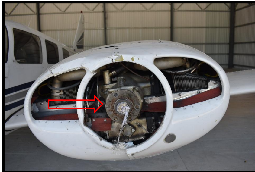
Fotografía No. 7 Daños en motor LH por paro repentino.
