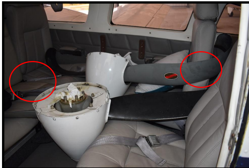
Fotografía No. 11 Daños en la hélice LH por deformación de las palas.
